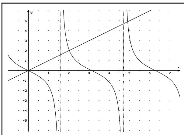
Wenn man keine Skizze des Graphen von  $f$  anfertigt und sich denkt, dass die Extremstelle ungefähr in der Mitte zwischen den beiden Nullstellen  $0$  und  $\pi$  liegt, wird man das Newtonverfahren mit dem Startwert  $x_1 = 1,5$  beginnen:
