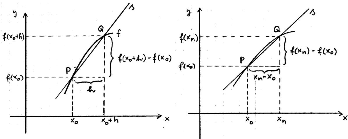
Will man die Steigung in einem Punkt  $P(x_0/f(x_0))$  eines Graphen bestimmen, so erhält man einen Näherungswert, wenn man die Steigung  $\frac{f(x_0+h) - f(x_0)}{h}$  der Sekanten  $s$  berechnet. (Q darf natürlich nicht zu weit von P entfernt sein.)
