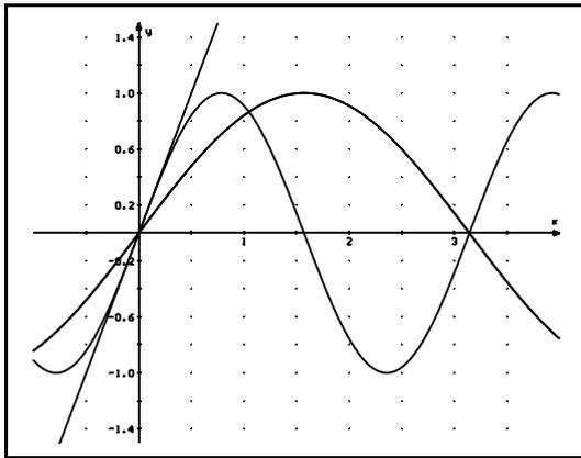
Die Steigungen der Sinusfunktion und der Kosinusfunktion haben an keiner Stelle einen größeren Wert als 1 und natürlich auch keinen kleineren als - 1. Der Graph, der zu  $f(x)=\sin(2x)$  gehört, verläuft aber im Ursprung deutlich steiler als der Graph der Sinusfunktion. (Links ist die Tangente an den zu  $\sin(2x)$  gehörenden Graphen eingezeichnet.)
