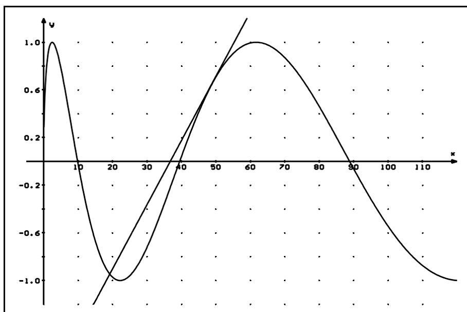
Oben wurde an der Stelle 49 die Tangente an den durch  $f(x) = \sin(\sqrt{x})$  definierten Graphen eingezeichnet.
