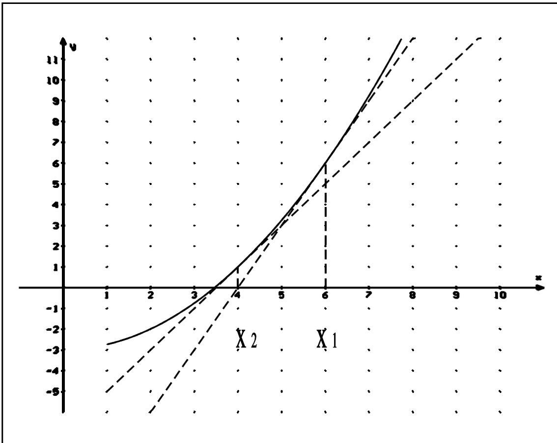
Es soll näherungsweise die Nullstelle des Graphen von  $f$  (durchgezogen) bestimmt werden. Im Punkt  $(x_1 / f(x_1))$  wird eine Tangente an den Graphen von  $f$  gelegt. Man bestimmt den Schnittpunkt  $x_2$  dieser Tangente mit der  $x$ -Achse. Im Punkt  $(x_2 / f(x_2))$  wird wieder eine Tangente an den Graphen .....
