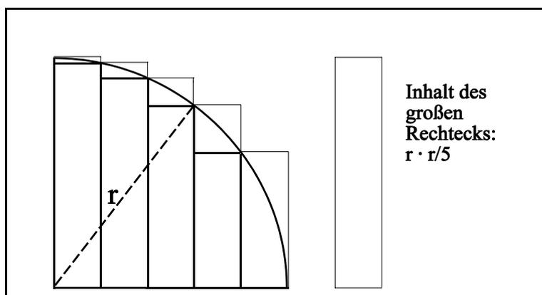
Man kann den Radius eines Kreises in fünf gleiche Teile unterteilen. Dann lassen sich dem Viertelkreis mit dem Radius  $r$  vier gleichbreite Rechtecke einbeschreiben. Gleichzeitig werden fünf Rechtecke umbeschrieben. Der Flächeninhalt der umbeschriebenen Rechtecke ist um  $r^2/5$  größer als der Inhalt der einbeschriebenen Rechtecke. Der Inhalt des Viertelkreises liegt zwischen dem Inhalt der einbeschriebenen und dem der umbeschriebenen Rechtecke:
