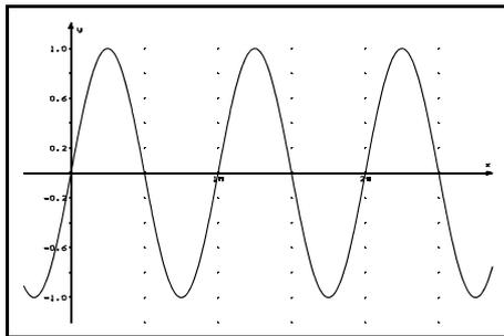
Der Graph der durch  $g(x) = \sin(2x)$  definierten Funktion "absolviert"<sup>5</sup> im Intervall  $[0/2\pi]$  zwei volle Schwingungen.
