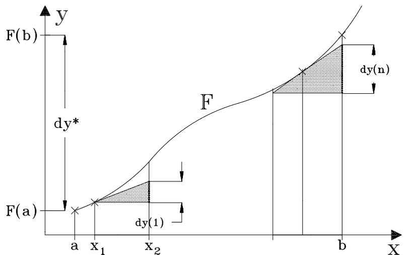
Was passiert, wenn man im oberen Diagramm das Differential  $dx := b - a$  wählt? - Damit „entartet“ das Integral zu einem Summanden eines geeigneten Differentials:  $dy^*$ .
